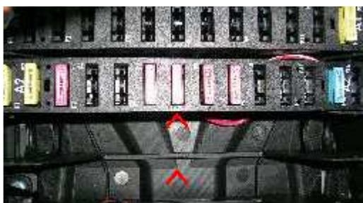
Sicherung in der Steuerung rechts hinter dem Fahrerhaus
